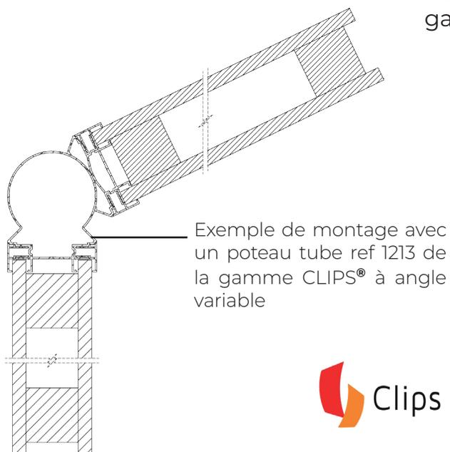
Exemple de montage avec profil 73 de la gamme clips®
